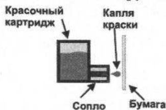
Рис. 4.16. Принцип формирования изображения на струйном принтере
