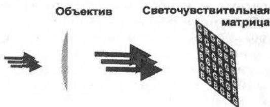
Рис. 4.10. Устройство цифровой фотокамеры
